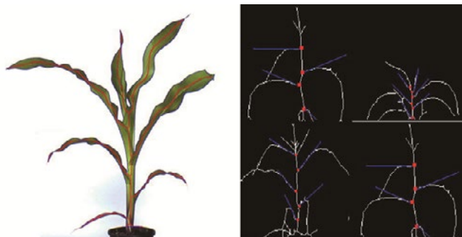
Scanalyzer 3D 可见光成像分析玉米植株骨架及叶倾角
