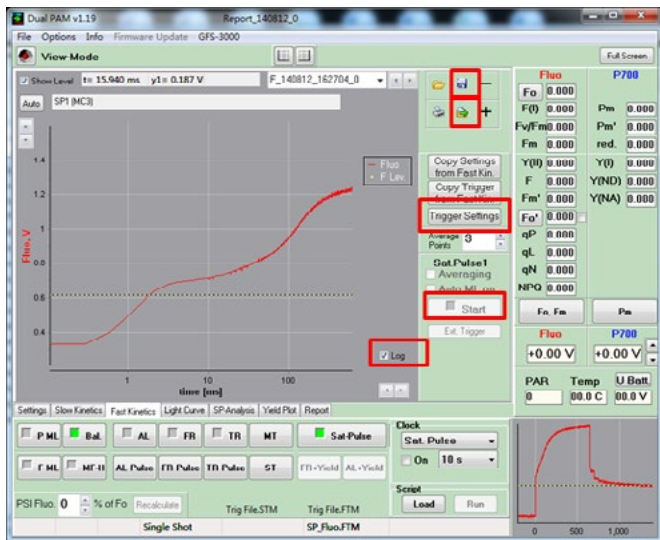
图 2.5.4.1 利用 Dual-PAM-100 测量蓝藻光化光关闭后的荧光瞬时上升曲线
